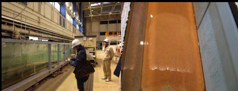
写真2 断面水槽による州島形成実験（五洋建設技術研究所）。リーフエッジの砕波によって、海面上に干出する州島が作られている（写真右）。
