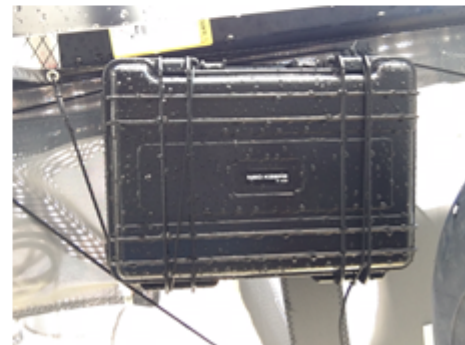
図3. 開発したモニタリングシステムを搭載したNACRA17 (試走前)
