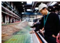
欠陥検査 エポキシ樹脂、ガラス繊維強化 バルサ等での製造風景
