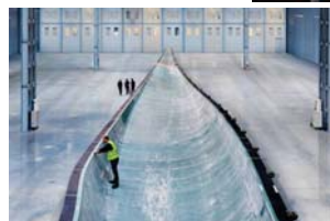
欠陥検査 エポキシ樹脂、ガラス繊維強化 バルサ等での製造風景
