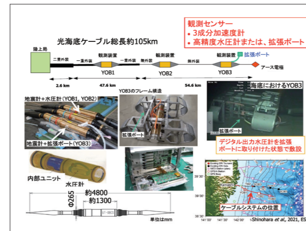
図4: インターネット技術を用いた海底ケーブル観測システム。2015年に岩手県釜石市沖に設置された。インターネット技術の導入により、小型化・低コスト化を図る共に保守性も向上した。システムの信頼性は、通信路及び構成機器の冗長化で確保している。
