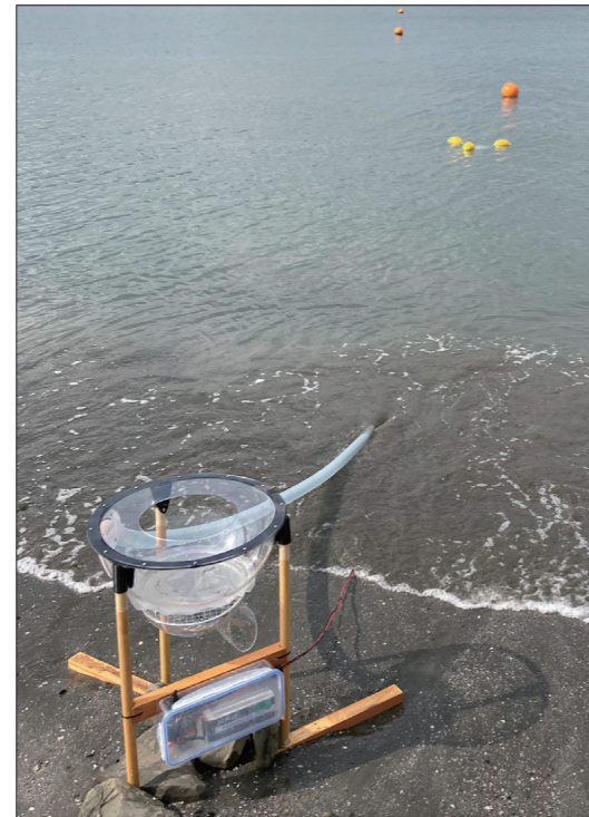
図3:マイクロプラスチック採取装置のプロトタイプの一例
