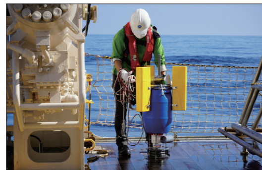
図4:試作したマイクロプラスチック採取装置を調査航海で実証試験
