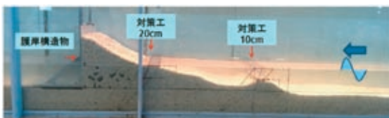
図3 透水性護岸によって、サンゴ砂礫が高潮位より上まで堆積する効果を検証した、水槽実験。特許出願中。
