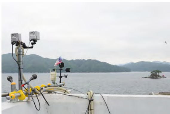
図2 国政沿岸海洋研究センター屋上に設置したライブモニタリングシステム。
