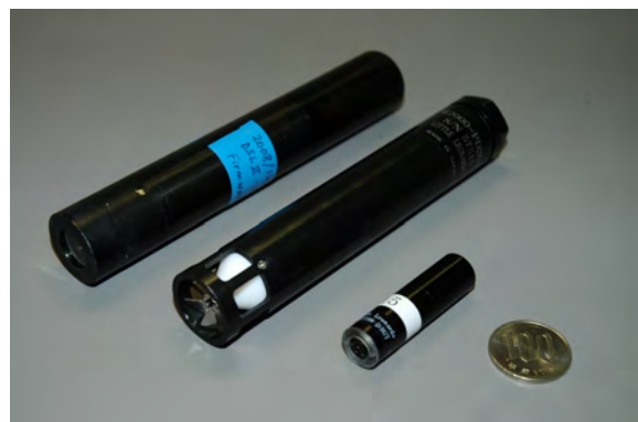
図1 現在主に使われている3種類の記録計。左より、静止画像記録計、速度加速度記録計、加速度記録計。
