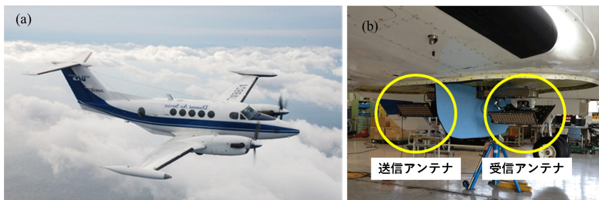
図 3.1 (a) 観測に用いた航空機、ダイヤモンドエアサービス社所有 King Air 200T (b)航空機腹部に取り付けた FM-CW レーダー。アルウェットテクノロジー社開発 AT SAR-X を使用。黄色丸で囲んだものがレーダーの送受信アンテナを示す。
