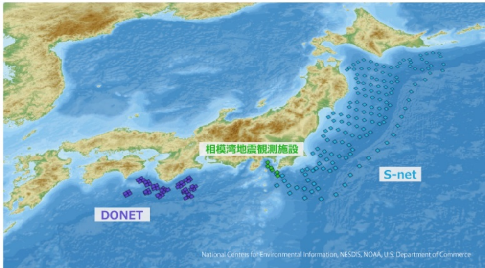
図 1.6 日本周辺海域のケーブル式海底津波・地震観測網 S-net、DONET、相模湾地震観測施設の観測点の分布。防災科学技術研究所 HP ( http://www.seafloor.bosai.go.jp ) より引用。
